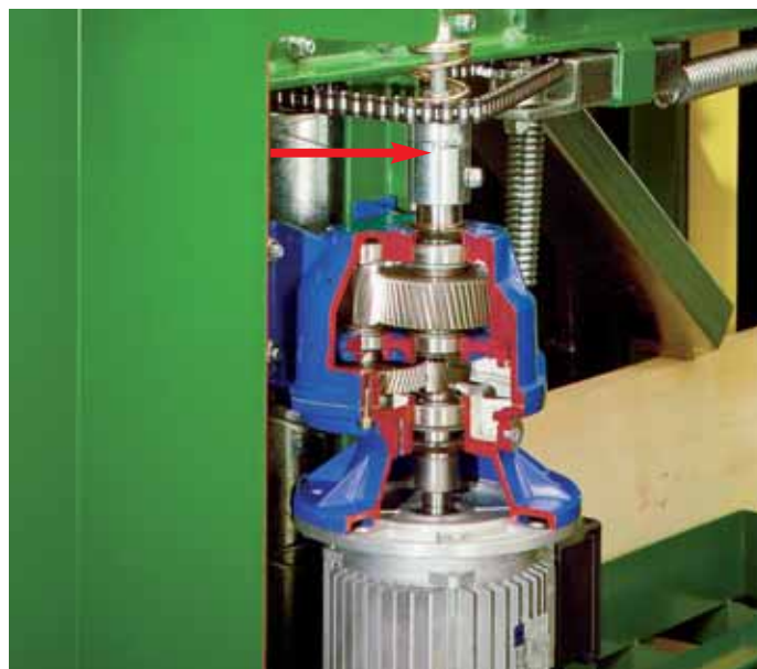
Giunto di sicurezza in versione trifase del motoriduttore coassiale.
