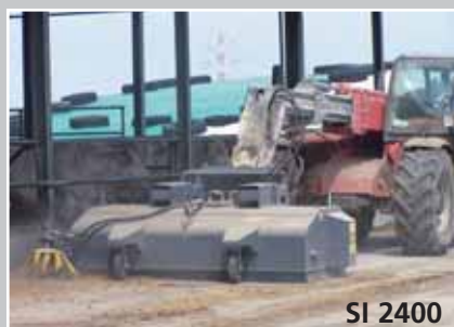
Spazzatrice industriale su telescopio Industrial polishing brush on telescopic handler
