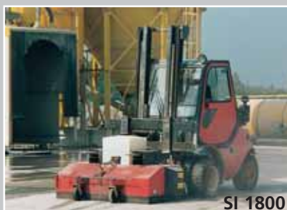
Spazzatrice industriale su carrello elevatore Industrial polishing brush on forklifts
