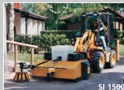
Spazzatrice industriale su pala caricatrice Industrial polishing brush on loaders
