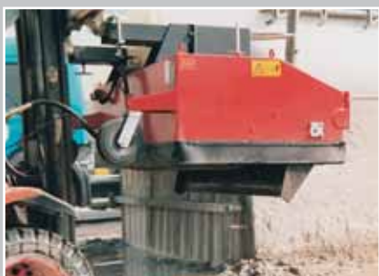
Spazzatrice industriale su telescopio Industrial polishing brush on telescopic handler
